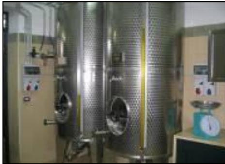
ويجب تخزين الزيت عند درجة حرارة ما بين 15-18 درجة مئوية، ويمكن تحقيق ذلك بإجراء عزل حراري في البناء وبالتحكم بدرجة حرارة خزانات الزيت بحيث تكون مزودة بمقياس للحرارة. ونظراً
